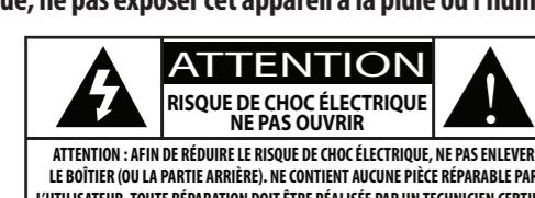
L'éclair fléché au centre d'un triangle équilatéral prévient l'utilisateur de la présence de « tensions élevées » dans l'appareil, pouvant constituer un risque de choc électrique pour les personnes, en cas de mise en contact avec les composants internes.
