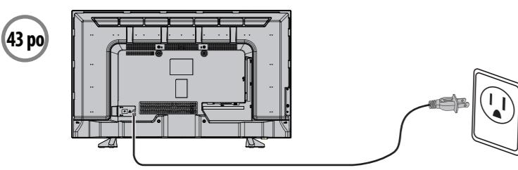
Brancher le cordon d'alimentation sur la prise d'entrée c.a. située au dos de l'appareil et brancher l'autre extrémité sur une prise secteur.
