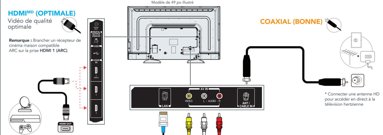
\* Connecter une antenne HD pour accéder en direct à la télévision hertzienne
