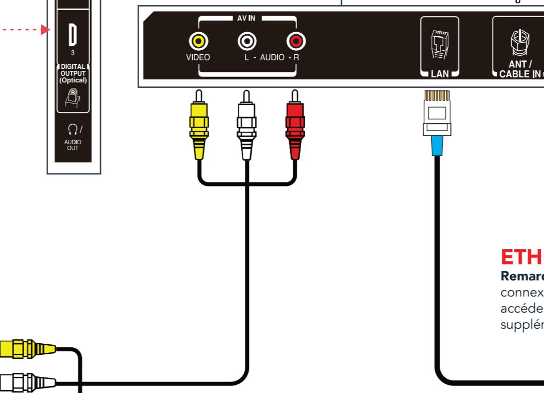
**ETHERNET (EN OPTION)****Remarque:** Il est nécessaire d'établir une connexion LAN (Ethernet) ou Wi-Fi pour accéder à l'Internet. Voir les détails supplémentaires au dos.
