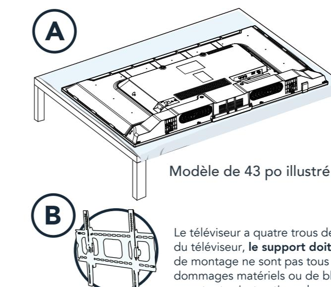
**Système de montage VESA****43 po** 200 x 300 – Vis de type M6 x 25 mm (4)**50 po** 400 x 200 – Vis de type M6 x 25 mm (4)**55 po** 200 x 300 – Vis de type M6 x 20 mm (4)
