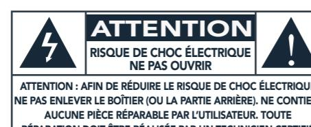
L'éclair fléché au centre d'un triangle équilatéral prévient l'utilisateur de la présence de « tensions élevées » dans l'appareil, pouvant constituer un risque de choc électrique pour les personnes, en cas de mise en contact avec les composants internes.
