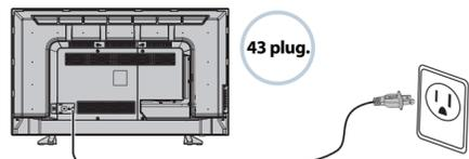
Enchufe el cable de alimentación en la toma de entrada de CA (AC IN) en la parte posterior de su televisor y enchufe el otro extremo en un tomacorriente.
