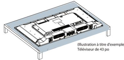
**B** Fixer chaque pied du socle du téléviseur au dos de celui-ci avec deux des vis fournies.
