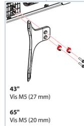
**B** Fixer un support du socle à chaque pied du socle avec deux des vis de 12 mm (les vis longues) fournies.
